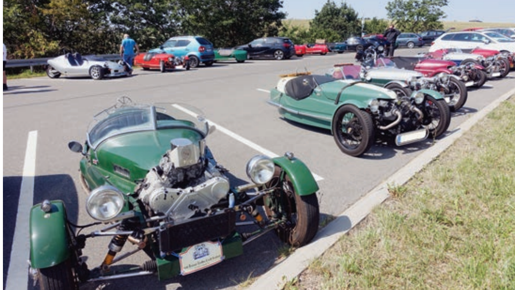
Vorne ein JZR mit dem V4-Motor aus der Honda Pan European.
