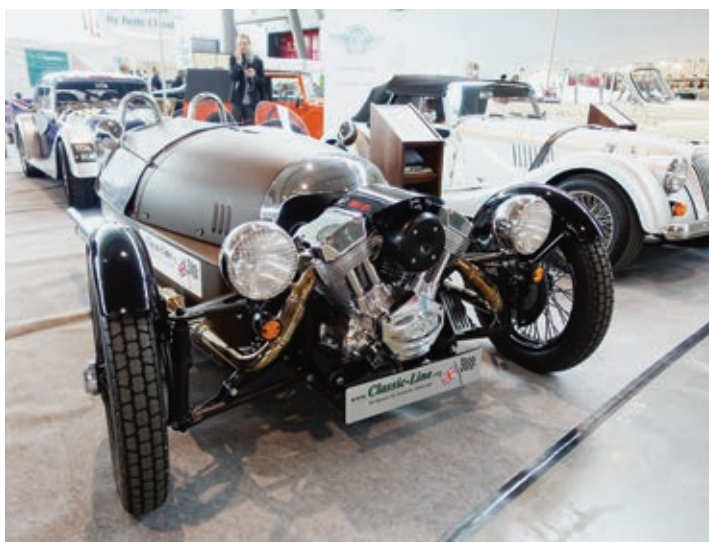
Der neue Morgan mit amerikanischem S&S-Motor.
