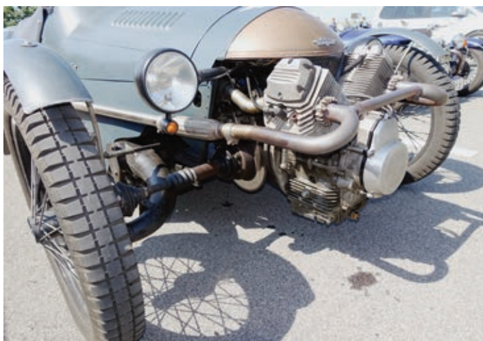
Rechts: Genauso wie der Lomax basiert der Pembleton auf der Ente von Citroën. Hier mit kleinem Moto Guzzi-Motor, Frontantrieb und innen liegenden Scheibenbremsen.
